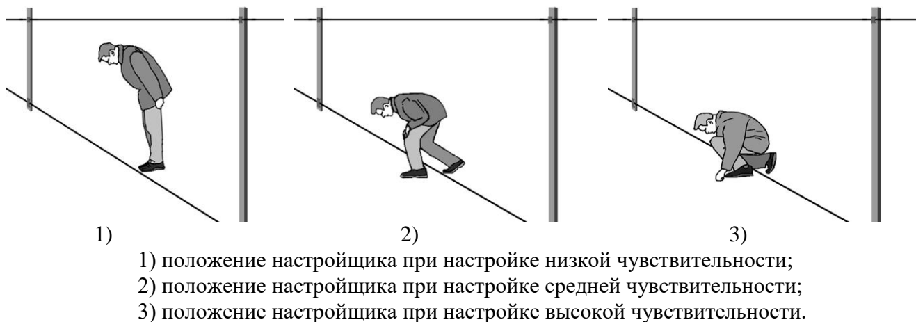
Рисунок 2.11 – Способы имитаций преодоления 30 при приземном варианте установки.
