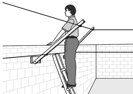
Рисунок 2.10 – Способ имитации преодоления ЗО при козырьковом варианте установки.
